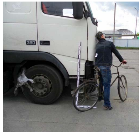
Рис 3. Натурне моделювання технічно спроможної експертної версії щодо взаємного розташування в момент контактування передньої частини вантажного автомобіля «VOLVO FH12» та потерпілого, який пішки рухається в попутному напрямку з вантажним автомобілем і веде велосипед поруч з собою праворуч.
