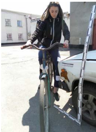
Рис 1. Відтворення розташування передньої частини автомобіля «ВАЗ 21051» і велосипедистки в момент контактування між ними.
