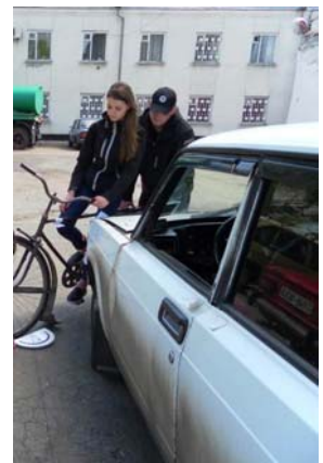
Рис 1. Відтворення розташування передньої частини автомобіля «ВАЗ 21051» і велосипедистки в момент контактування між ними.
