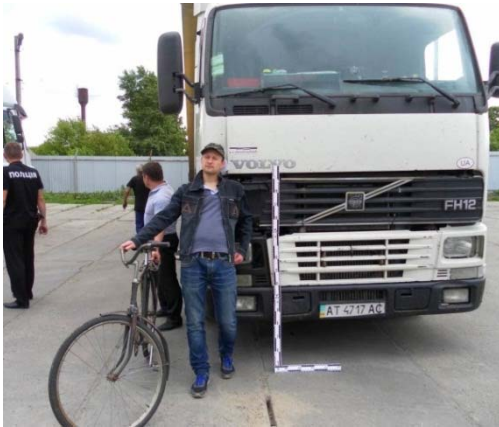
Рис 4. Натурне моделювання технічно неспроможної експертної версії щодо взаємного розташування в момент контактування передньої частини вантажного автомобіля «VOLVO FH12» та потерпілого, який рухається на велосипеді в попутному напрямку з вантажним автомобілем.
