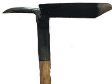
Рис. 5.41. Німецька піхотна складана лопата з киркою (1964)
