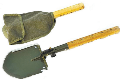
Рис. 5.46. Австрійська саперна складана лопатка Glock у розкладеному положенні з висунутою пилкою
