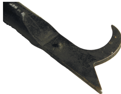
Рис. 4.3. Робоча частина багра (наконечник)
