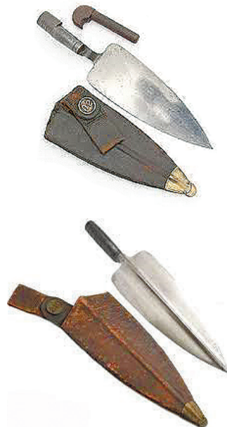
Рис. 5.91. Американська багнет-лопата конструкції Чилінгворта-Меткалфа зразка 1873 р.
