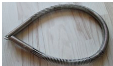
Рис. 1.290. Гвинтова пружина без била та обмотки руків'я
