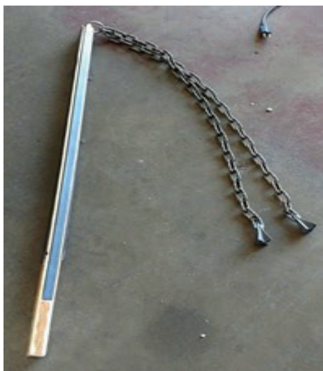
Рис. 3.267. Ціп подвійний з пірамідальними сталевими билами хрестоподібного перетину
