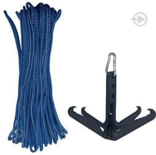
Рис. 6.5.23. Сучасна кішка для розмінування
