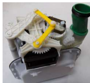
Фото 6. Вимірювальний механізм лічильника газу
