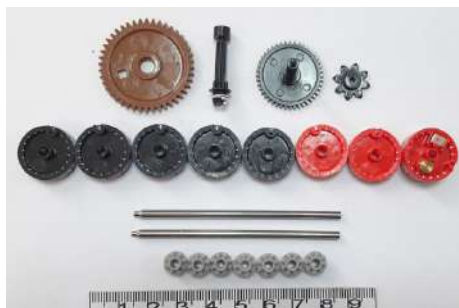
Фото 4, 5. Деталі лічильного механізму
