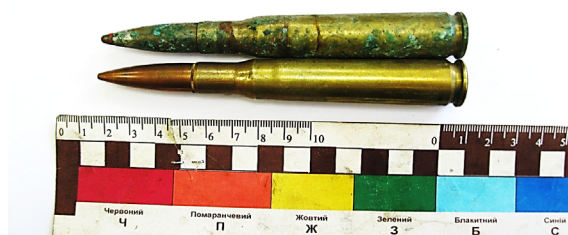
Рис. 9. Патрон калібру 12,7 \times 99 мм ( 12,7 \times 99 мм NATO, .50 BMG) із кулею зі сталевим осердям
