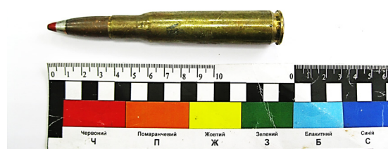
Рис. 8. Патрон калібру 12,7 \times 99 мм API-T ( 12,7 \times 99 мм NATO, .50 BMG) із бронебійно-запалювально-трасуючою кулею
