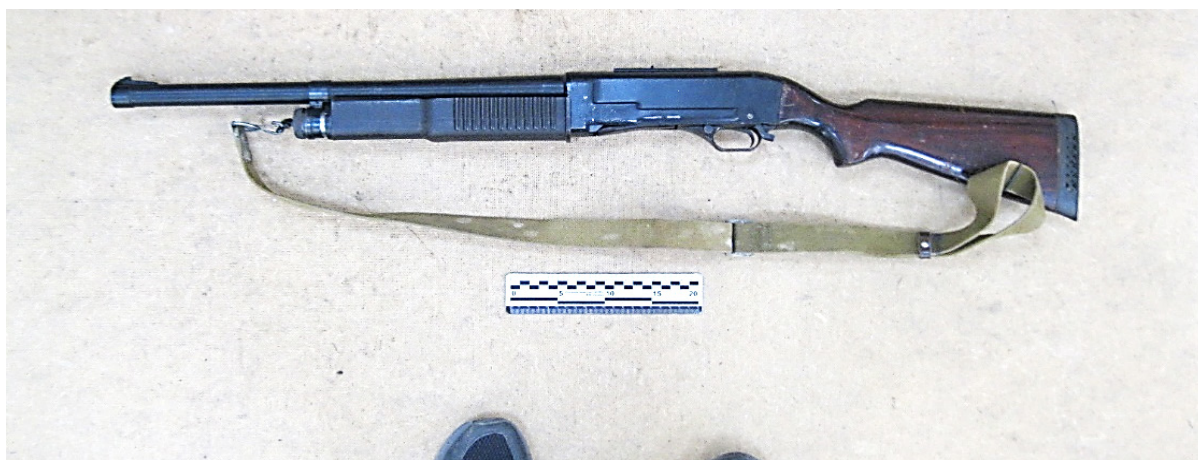
Рис. 2. Нарізний поліцейський карабін калібру 23 мм моделі КС-23
