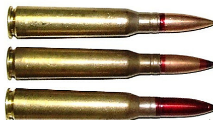
Рис. 10. Патрон 12,7 мм із запалювальною кулею миттєвої дії МДЗ (7-3-2)
