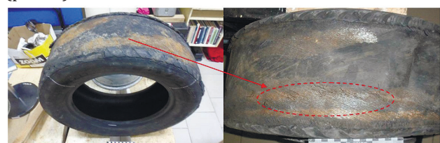
Рис. 5. Локальна зона на оголеній сітці сталевго брекера, яка відрізнялася наявністю корозії та стиранням металевих ниток та шару гуми
