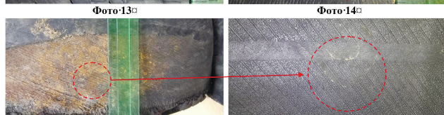
Рис. 6. Зони виявленого наскрізного пошкодження на фрагменті протекторної частини з відсутністю фрагмента гуми та відсутності пошкодження в цій же зоні сітки брекера балону шини після їх зіставлення між собою
