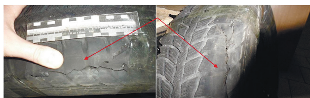
Рис. 4. Експлуатаційний знос внутрішньої плечової зони шини
