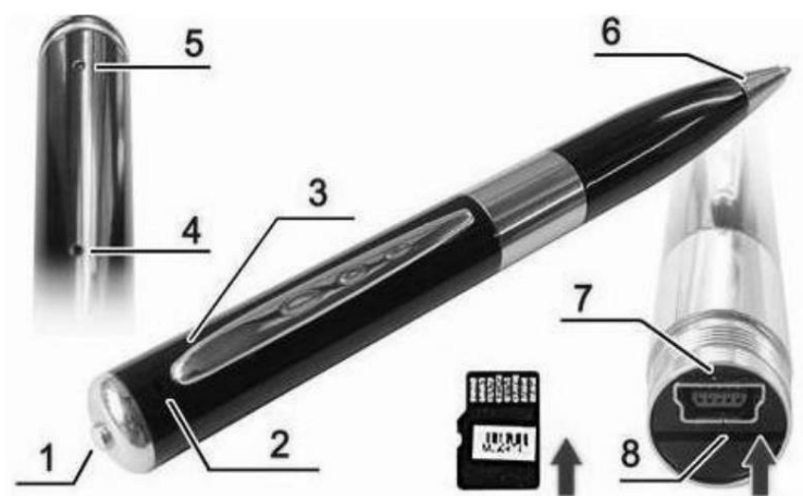
Рис. 2.9 Система прихованого відеозапису, вбудована в авторучку: 1 – кнопка «Вкл./викл.»; 2 – камера; 3 – мікрофон; 4 – кнопка «Скинути налаштування»; 5 – індикатор статусу; 6 – кулькова ручка; 7 – порт USB; 8 – картоприймач
