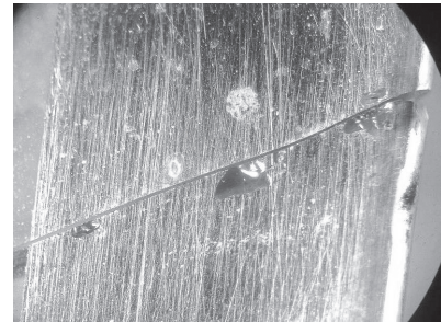
Рис. 12. Взаємоперехідні подряпини на виробах зі скла
