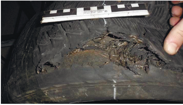
Рис. 7. Зона відсутнього фрагменту протекторної частини, яка має масивну сплутаність та збільшену сажність гумового шару
