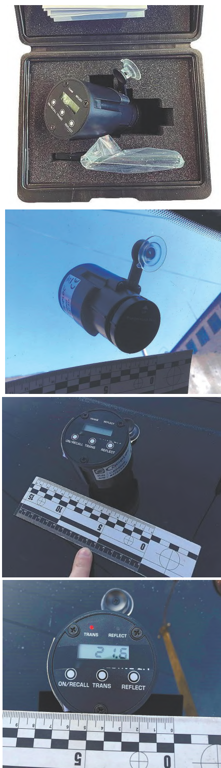
Рис. 1—4. Проведення вимірювання рівня світлопропускання скла приладом «CAP5600»
