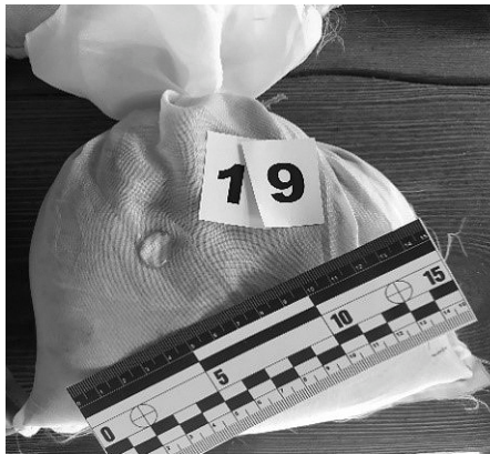
Рис. 13.6. Вияв властивості гідрофобності (крапля води не всмоктується в матеріал)
