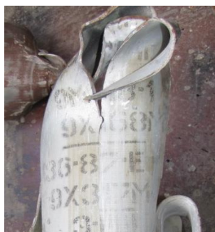
Рис. 2.30 Фотозображення загального вигляду маркувальних позначень на ракетній частині досліджуваного об'єкта, виявленого на місці вибуху
