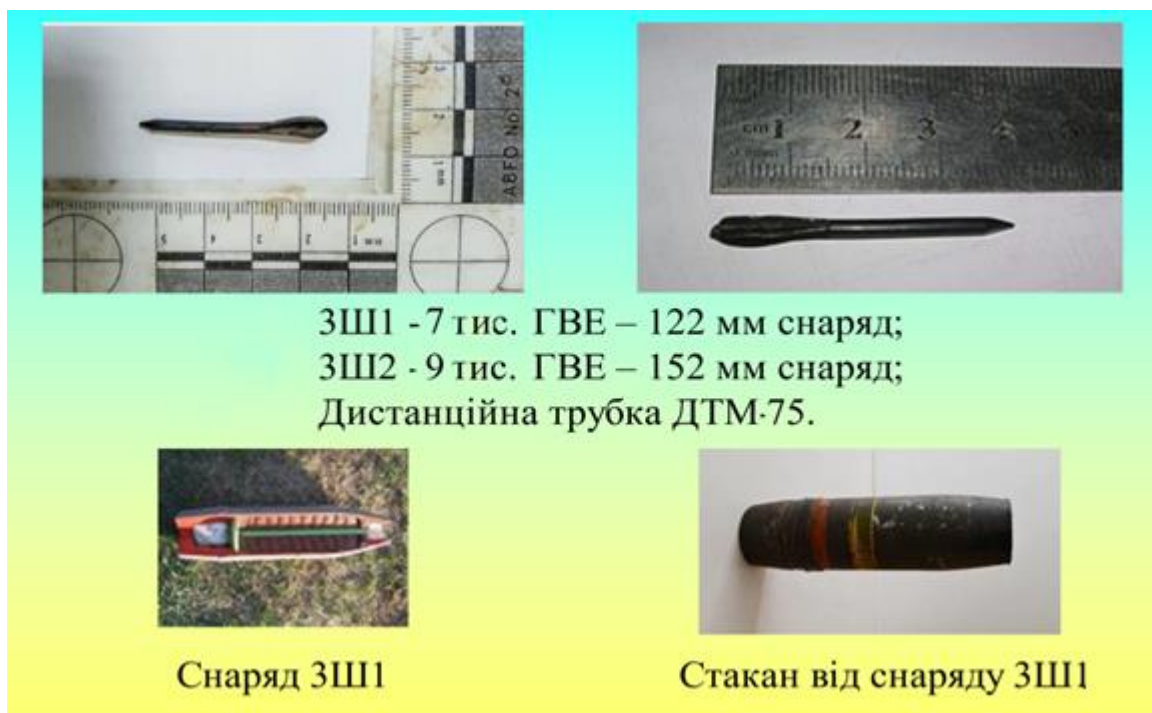
Рис. Б.7 Готові уражаючі елементи стрілоподібного типу («Флешета»), якими споряджаються шрапнелі артилерійські снаряди
