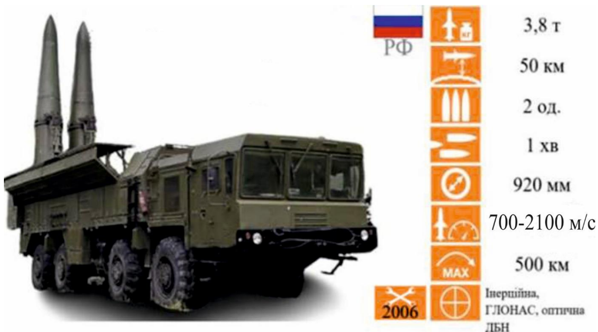
Рис. Б.11 Ракетне озброєння ворога, що застосовується проти України, – оперативно-тактичний ракетний комплекс 9K720 «Іскандер»
