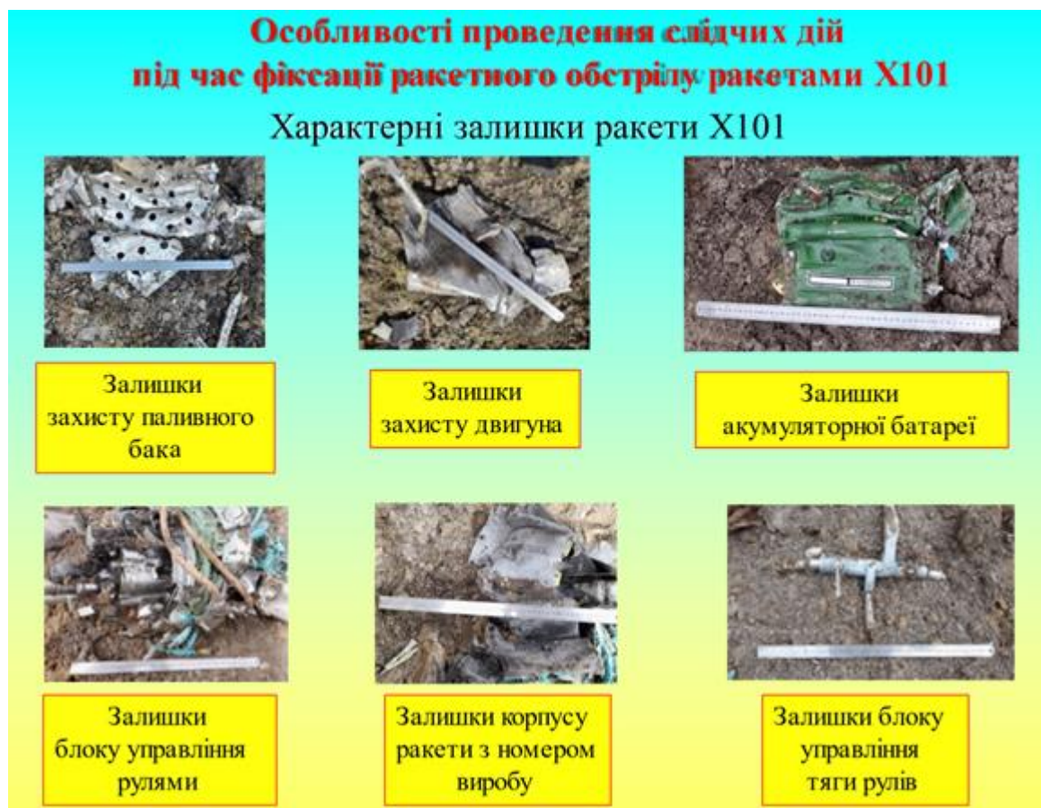
Рис Б.13 Залишки авіаційної крилатої ракети Х-101
