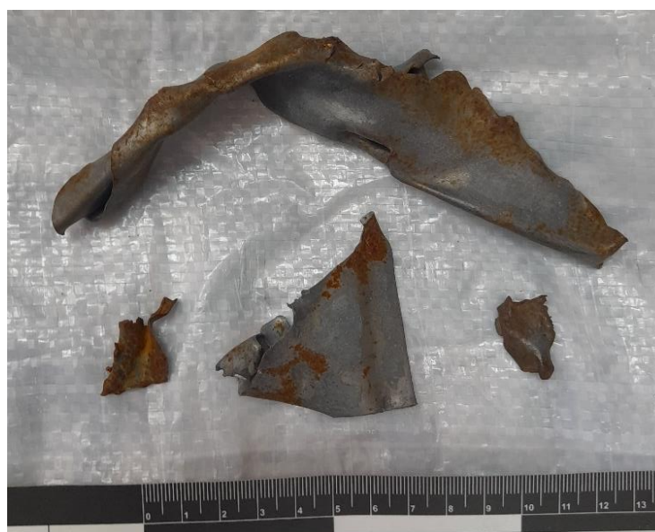
Рис. 2.35 Загальний вигляд вторинних осколків, утворених унаслідок вибуху та руйнації побутової техніки й елементів конструкції будівлі та виявлених під час огляду території будівлі
