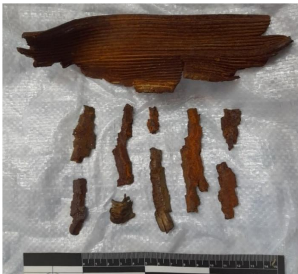
Рис. 2.34 Загальний вигляд осколків бойової частини боєприпасу, що виявлені під час огляду території будівлі
