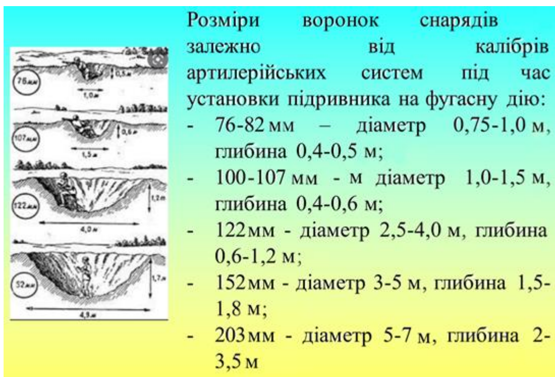
Рис Б.2 Установлення типів озброєння за характеристиками воронки на місцях прильотів.
