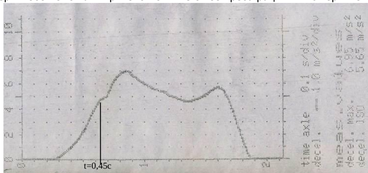
Рисунок 6.3 — Деселогорама гальмування автомобіля DAF XF105 реєстраційний номер AX 6515 EI з напівпричепом KOGEL S24-1 реєстраційний номер AX 7697 XO
