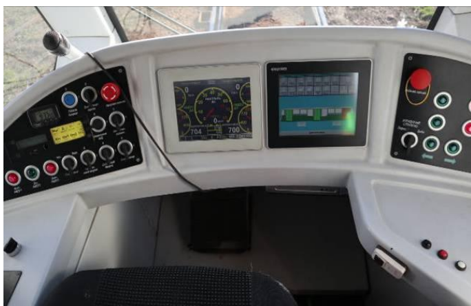
Рисунок 3.5 — Загальний вигляд панелі приладів трамвая Tatra T3 ВПНП бортовий номер 575
