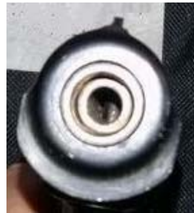
Рис. 6, 7. Леер та штифт у стволі пістолета ПМСХ.
